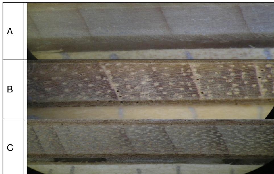
Figura 4: Anéis de crescimento ampliados com uso da lupa Leica Stereo Zoom acoplada à mesa de medição LINTAB6, sendo: A: *Araucaria angustifolia*; B: *Cedrela fissilis*; C: *Ocotea porosa*. Aumento 3 vezes.
