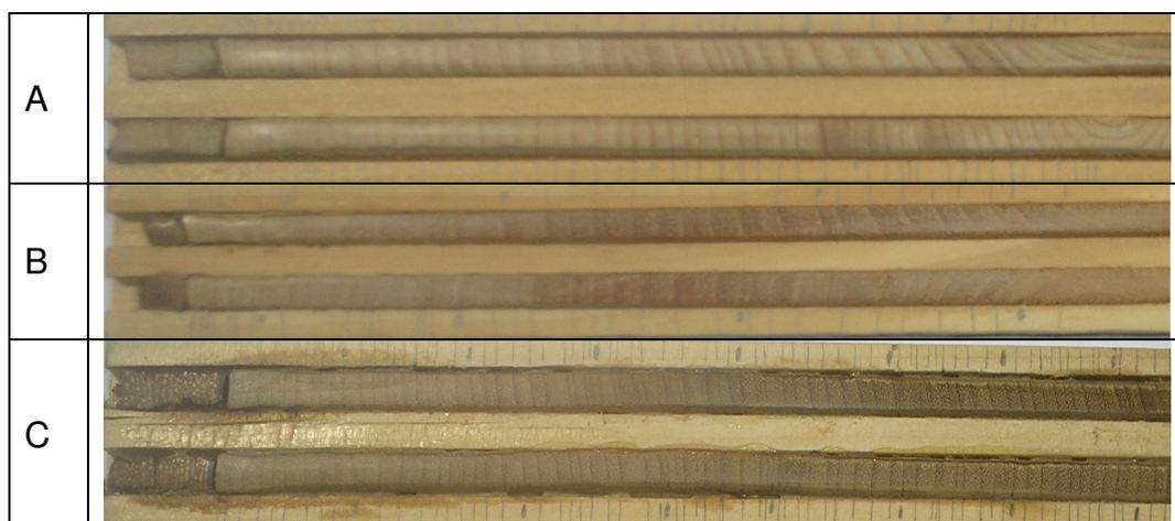
Figura 3: Exemplo das amostras preparadas para a medição com o LINTAB6, sendo: A: *Araucaria angustifolia*; B: *Cedrela fissilis*; C: *Ocotea porosa*
