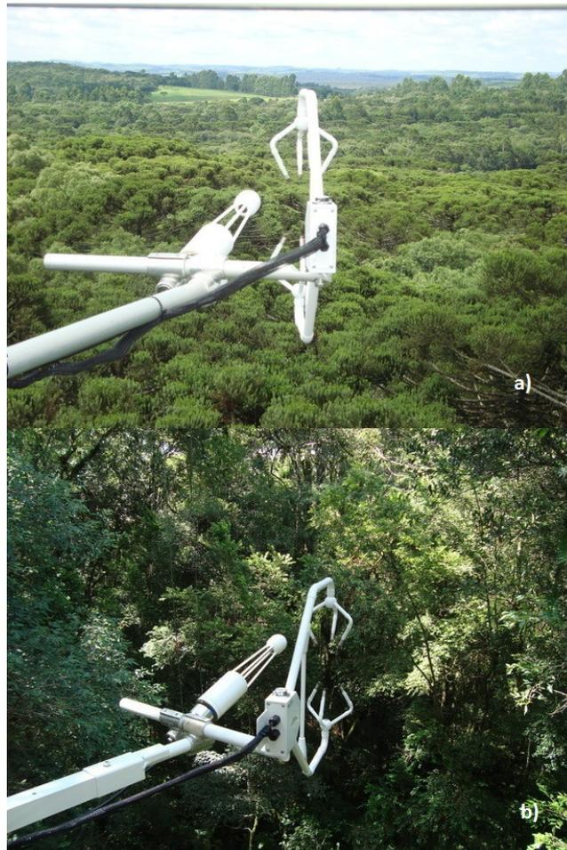
Figura 2: Sistema de covariância de vórtices: anemômetro sônico e analisador de gás acima (a) e no interior (b) da floresta.
